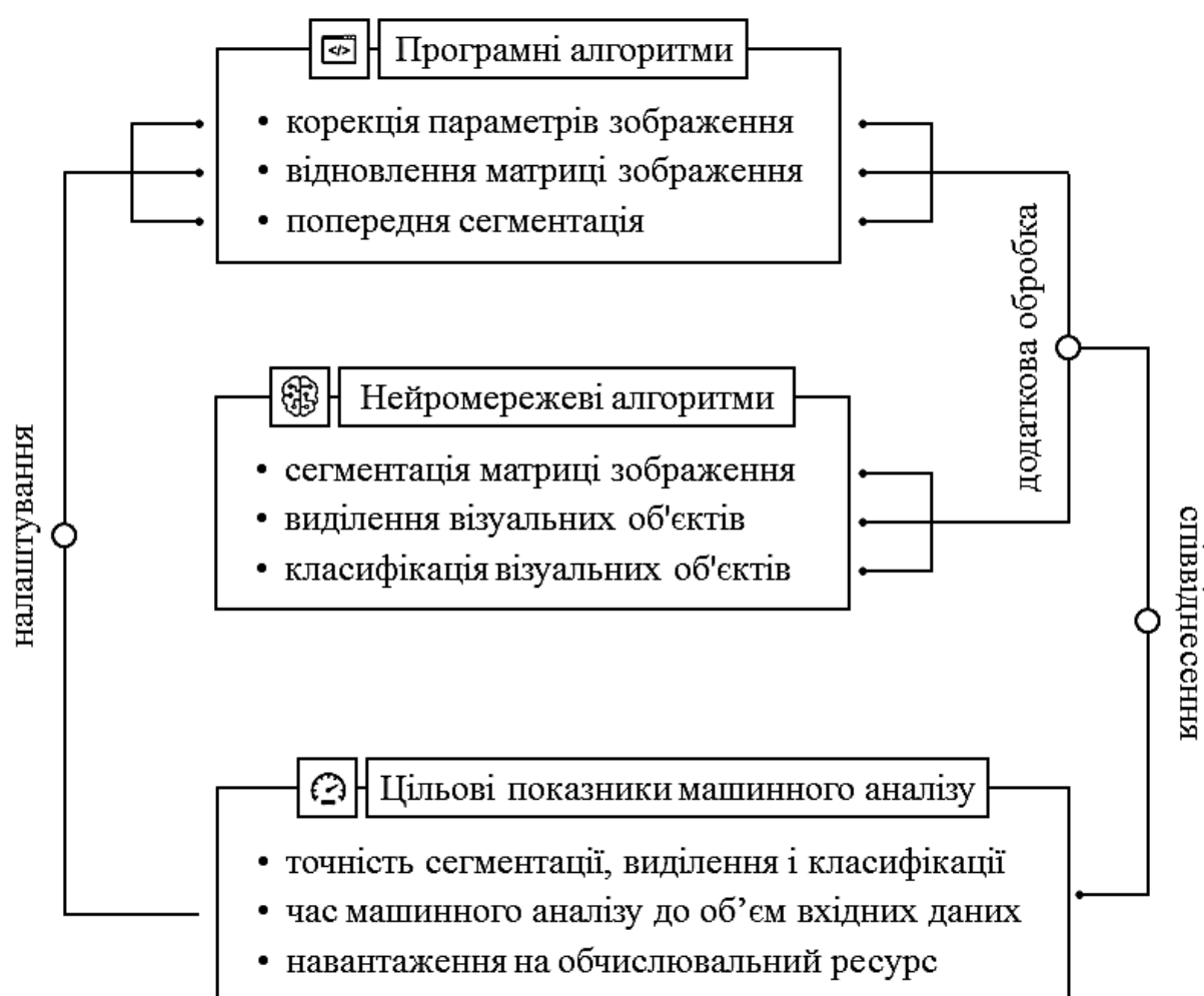
Рис. 1. Схема попередньої обробки матриці зображення з метою збільшення ефективності застосування нейромережових алгоритмів
